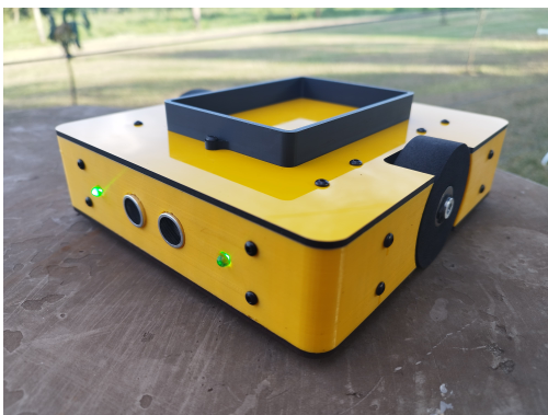
Figura 7. Versão final do protótipo do AGV [31].
