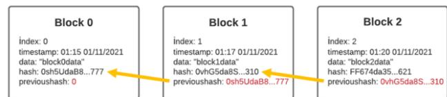
Figura 1. Exemplo de cadeia de blocos em uma *blockchain*. Adaptado de [14].
