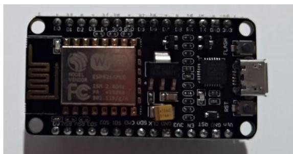
Figura 1. NodeMCU com ESP8266
