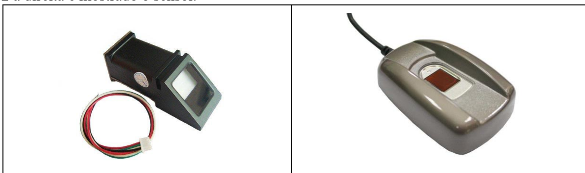
Figura 2. À esquerda Sensor Óptico. À direita sensor capacitivo.
