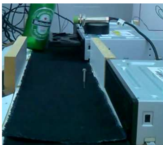
Figura 11 – drives de CD usados como atuadores
