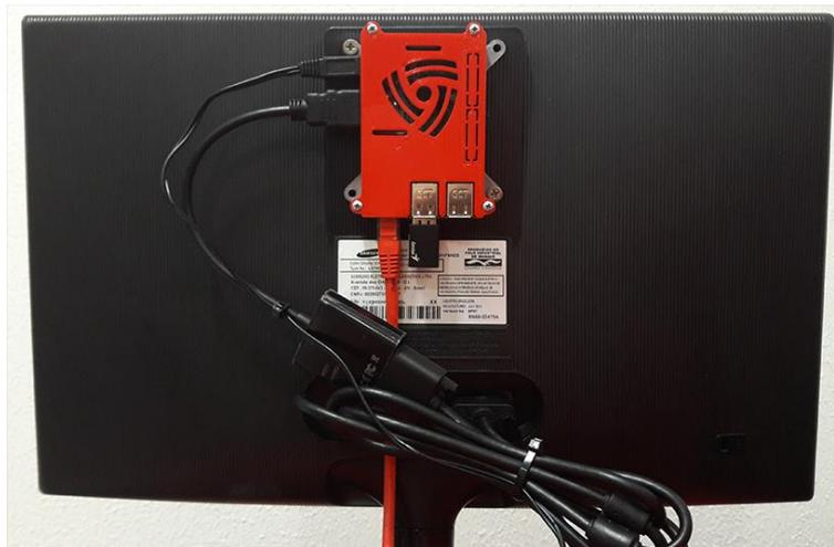
**Figura 2. Raspberry Pi fixado ao monitor dentro de um case vermelho.**
